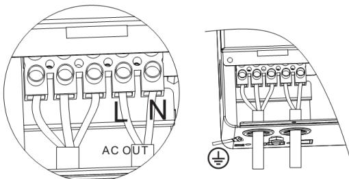
注意：接地线缆尽量用粗线径（导线截面积不小于  $4mm^2$ ），接地点尽量靠近一体机，接地线越短越好。
